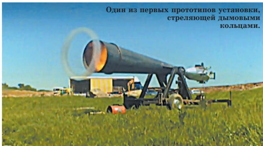
Один из первых прототипов установки, стреляющей дымовыми кольцами.
